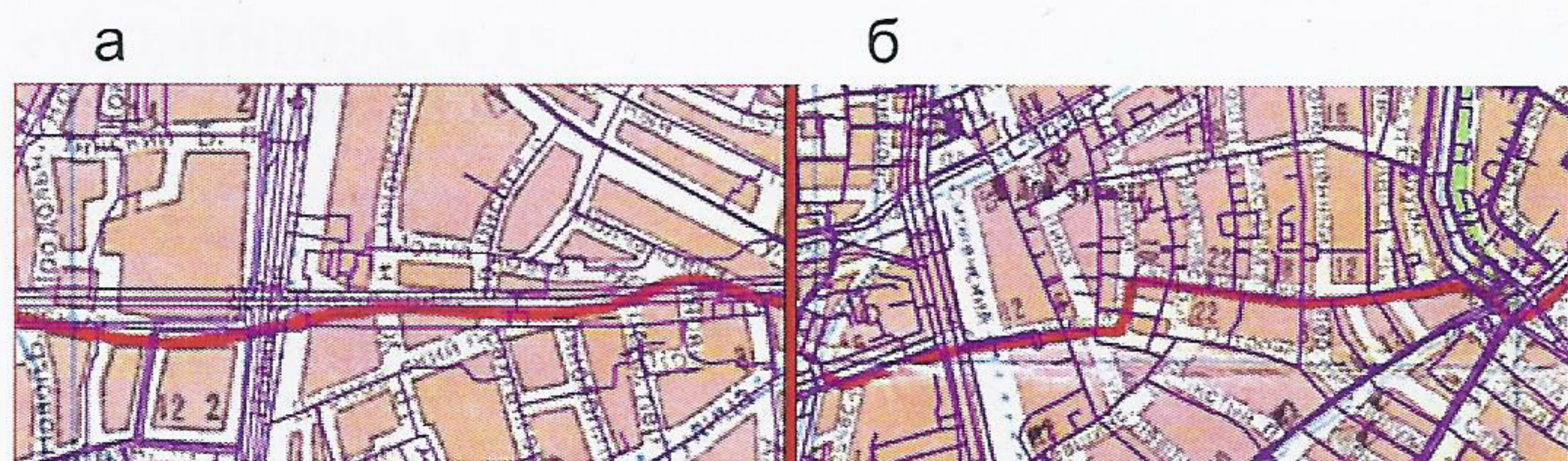
Рис. 2. Несовпадение контуров улиц, с их изображением на растре: а - изменение улицы; б- систематические смещения.
